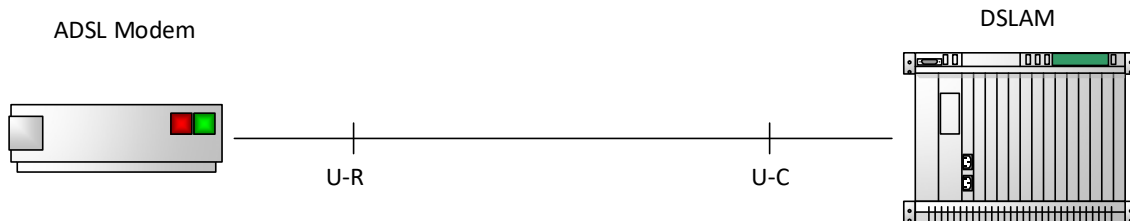
Abbildung 2.1 Schematische Darstellung ADSL-Anschluss
