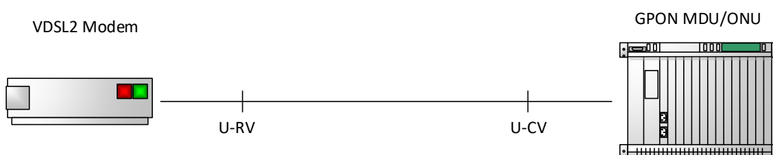
Abbildung 3.1 Schematische Darstellung VDSL-Anschluss (FTTB)
