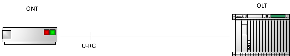
Abbildung 6.1 Schematische Darstellung GPON Anschluss (FTTH)
