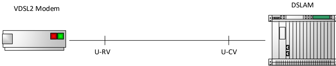
Abbildung 4.1 Schematische Darstellung VDSL-Anschluss (FTTC)
