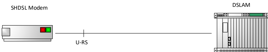
Abbildung 5.1 Schematische Darstellung SHDSL-Anschluss
