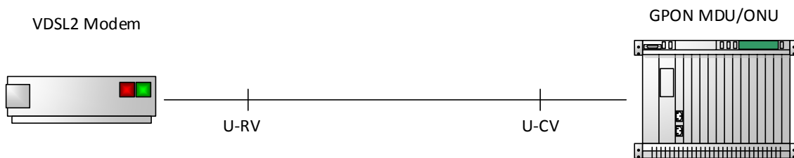
Abbildung 3.1 Schematische Darstellung VDSL-Anschluss (FTTB)
