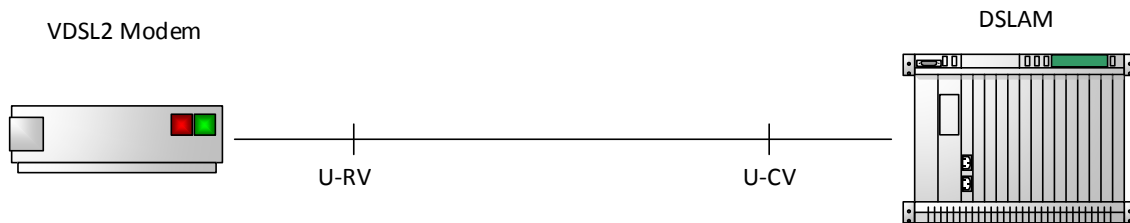
Abbildung 4.1 Schematische Darstellung VDSL-Anschluss (FTTC)
