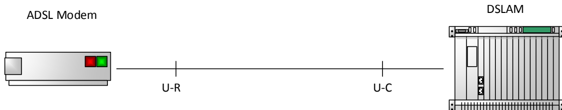
Abbildung 2.1 Schematische Darstellung ADSL-Anschluss
