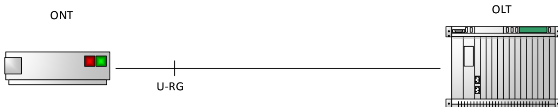
Abbildung 6.1 Schematische Darstellung GPON Anschluss (FTTH)
